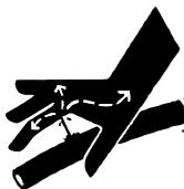
Não verifique vazamentos em circuitos hidráulicos com as mãos, jatos de alta pressão podem provocar ferimentos.
