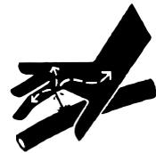
Não verifique vazamentos em circuitos hidráulicos com as mãos, jatos de alta pressão podem provocar ferimentos.
